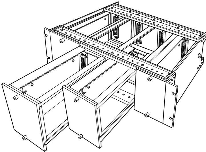
電子機器の回路をさらに細分化したり個々に目的をもたせた最小固体の電子機器にすることにより、トラブル発生ときにモジュールの交換がすぐにおこなえることから正常復帰に時間がかからないという最大のメリットがあります。
