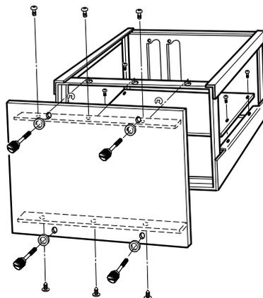
サブラックに2台格納できます。構成部品にアルミニウム押出型材と鉄板等を用い、パネルは「ホーニングB2アルマイト」、本体は「亜鉛めっき」仕上げを標準としています。本シリーズはシャーシが水平に取り付けられており、コネクタプレートが付属されています。コネクタプレートはサブラック側に取り付けます。両方にツーピースコネクタが取り付けられるよう、専用穴が空けてあります。
